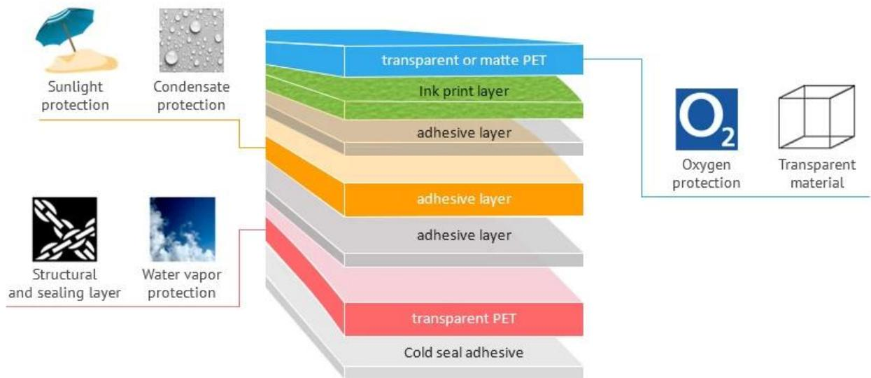
**СХЕМА 2** : двухслойный ламинат. Выбор между прозрачным или непрозрачным композитом зависит от того, хочет ли клиент посмотреть детали для демонстрации продукта.
